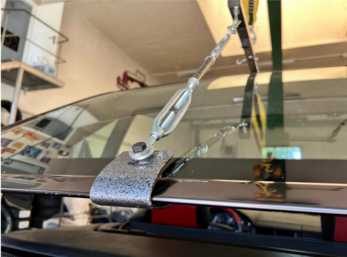
4. Jetzt können Sie Ihren Flachenzug oder den Haken der Winde mit der dicken Trägeröse (F) verbinden. Achten Sie darauf, dass das System so gerade wie möglich unter dem Dachhaken positioniert ist. Nun können Sie das Dach anheben. Halten Sie immer eine freie Hand am Hardtop, um dieses sicher zu führen. Nur so können Kratzer und Beschädigungen durch die Zapfen am Dach verhindert werden. Im Zweifelsfall sollte immer eine zweite Person mithelfen.
