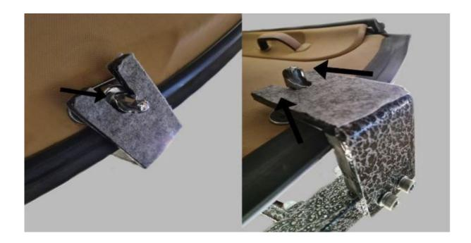
2. Lockern Sie nun die Schraubspanner, bis es Ihnen möglich ist, den hinteren Tragwinkel unter der Leiste Ihrer Heckscheibe einzuklemmen. Ist Ihnen dies gelungen, drehen Sie die Schraubspanner wieder fest. Drehen Sie die Spanner nur handfest, um ein Verbiegen zu vermeiden.
